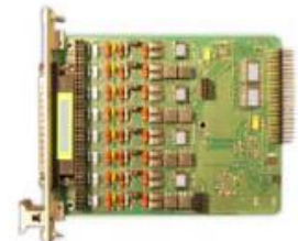
MC-227UP, модуль измерения относительного сопротивления с индивидуальной гальванической развязкой каналов
