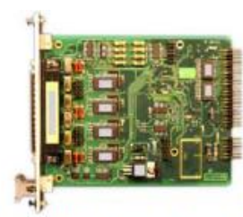
MC-212, модуль для работы с тензопотенциметрическими датчиками
