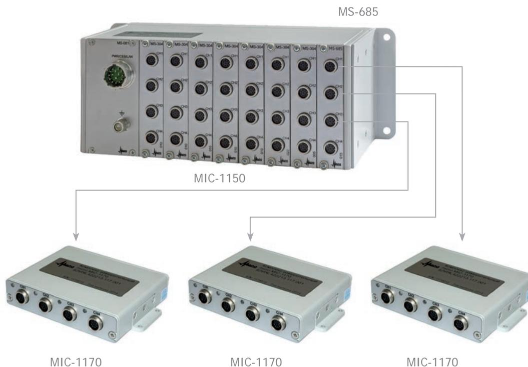
Для подключения MIC-1170 к MIC-1150, в регистраторе MIC-1150 используется модуль-контроллер MS-685. Возможны модификации MIC-1170 на базе модулей MS-142, MS-202, MS-304, MS-340.
