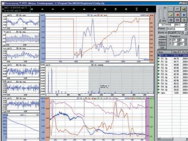
MR-300 – программное обеспечение для регистрации и обработки параметров динамических процессов в темпе эксперимента.
