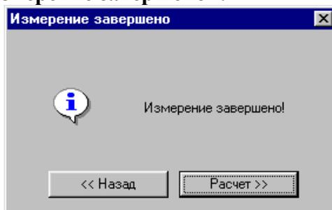
На данном этапе возможно возвращение к проведению калибровки в случае каких-либо ошибочных действий (кнопка "Назад") или проведение расчета погрешностей измерений (кнопка "Расчет"). При выборе расчета погрешностей измерения появляется диалоговое окно "Обработка и просмотр измеренных данных". Это окно позволяет оценить полученные результаты: значения измеренных сигналов в
