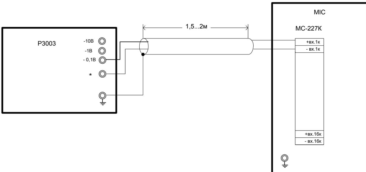
Рисунок 6. Схема подключений при поверке модулей МС-227К
