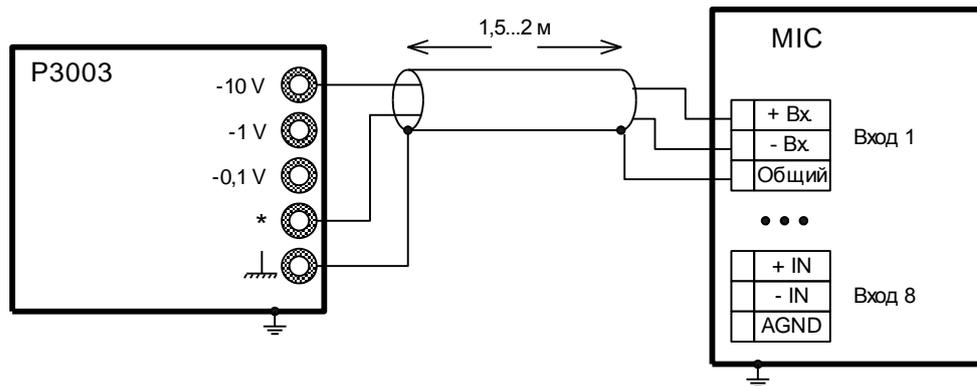
Рисунок 13. Схема подключений при определении неравномерности АЧХ на частоте 0 Гц
