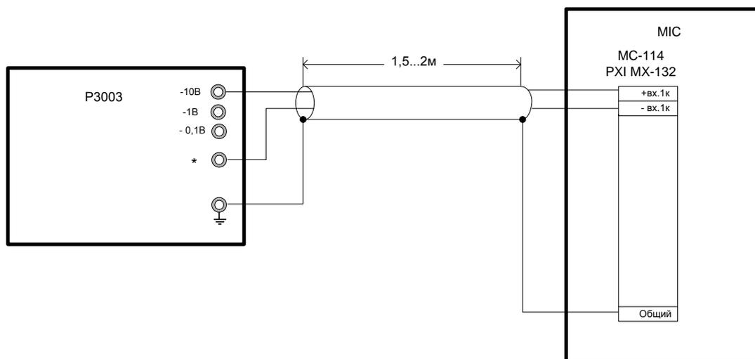
Рисунок 3. Схема подключений при поверке модулей МС-114, РХИ МХ-132
