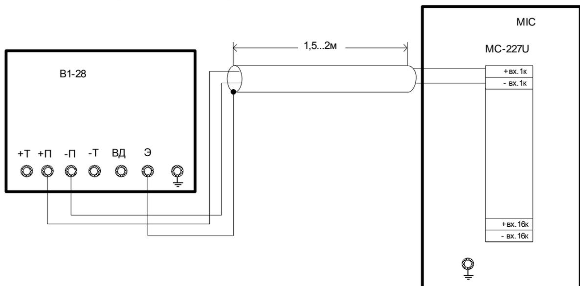
Рисунок 7. Схема подключений при проведении поверки модулей МС-227U.
