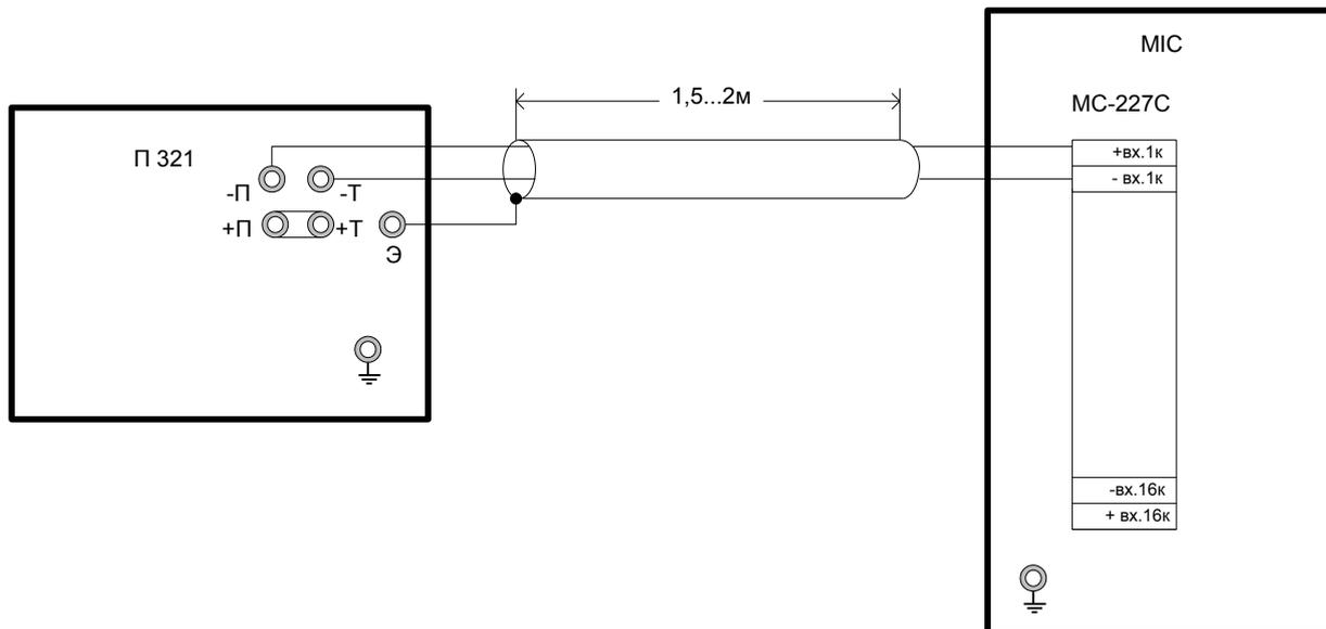
Рисунок 9. Схема подключений при проведении поверки модулей МС-227С
