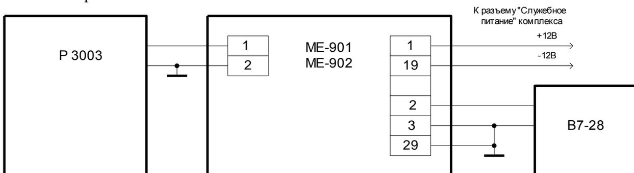
Рисунок 2. Схема для определения коэффициентов передачи барьеров взрывозащиты.
