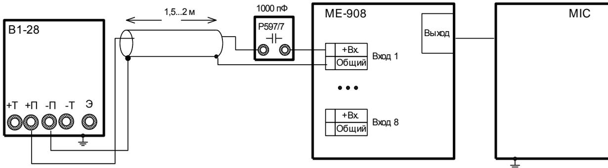
Рисунок 12. Схема подключений при проведении поверки ИК с усилителями заряда.
