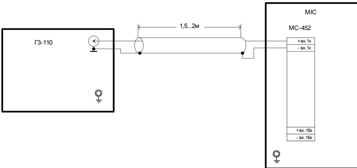
Рисунок 14. Схема подключений при определении погрешности измерения частоты.
