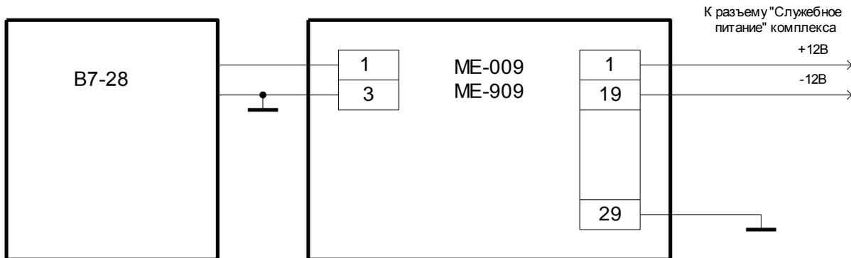
Рисунок 1. Схема для определения величины выходного напряжения модулей ME-009, ME-909.
