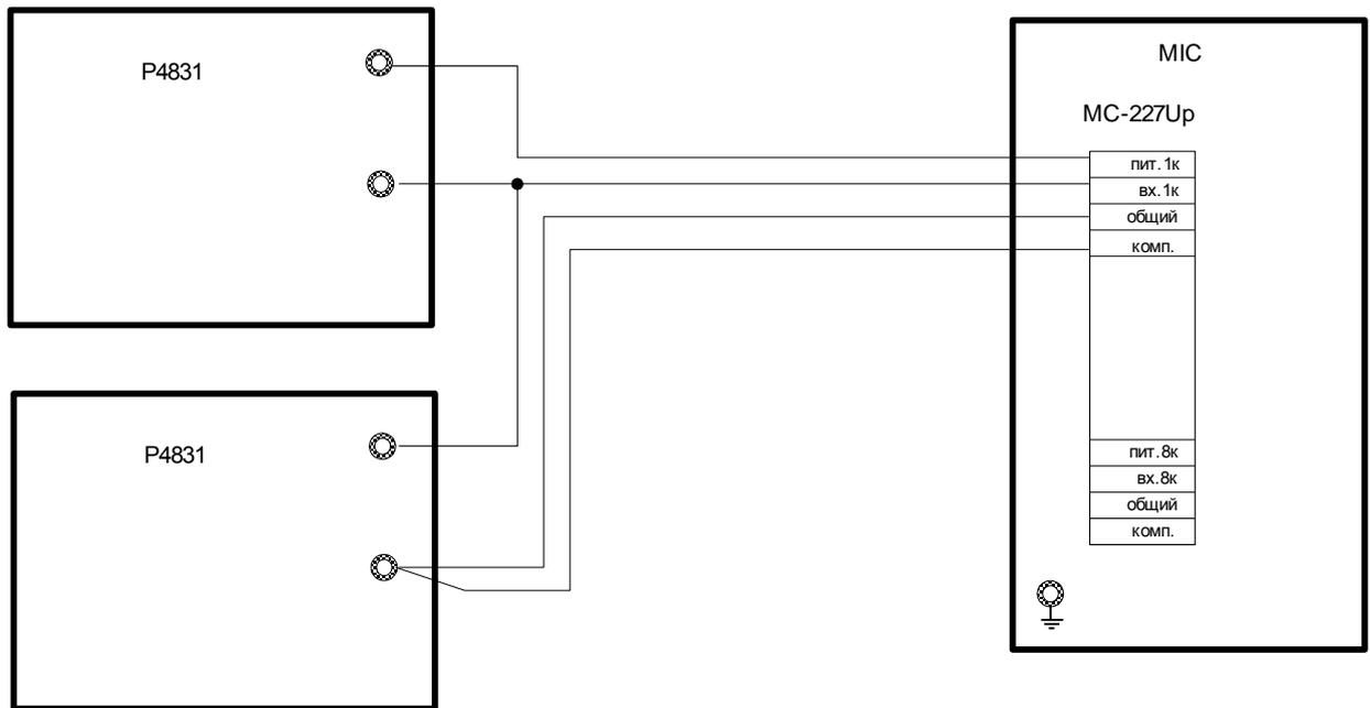
Рисунок 8. Схема подключений при проведении поверки модулей MC-227Up.
