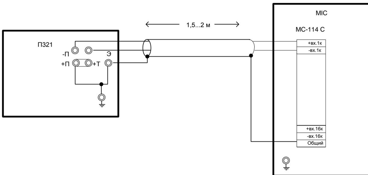
Рисунок 4.Схема подключений при проведении поверки модулей МС-114С.
