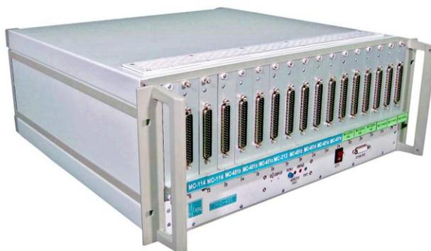
В крейт может быть установлено до 16-ти измерительных модулей. Дополнительно имеется возможность установки на шину РСІ ПЭВМ двух измерительных плат М2408, М2418 или М2428.
