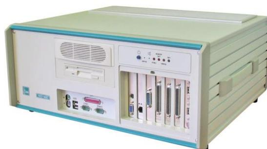
В слоты крейта может быть установлено до 16-ти измерительных модулей. Дополнительно имеется возможность установки на шину PCI встроенной ПЭВМ двух измерительных плат M2408, M2418 или M2428.
