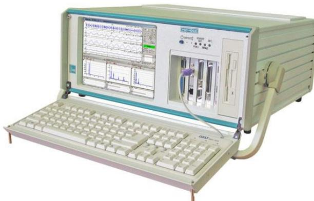
В слоты крейта может быть установлено до 16-ти измерительных модулей. Дополнительно имеется возможность установки на шину PCI встроенной ПЭВМ двух измерительных плат M2408, M2418 или M2428.
