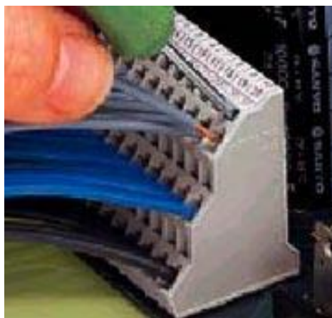
Рисунок 4 - Соединения проводников с контактами клеммной колодки WAGO
