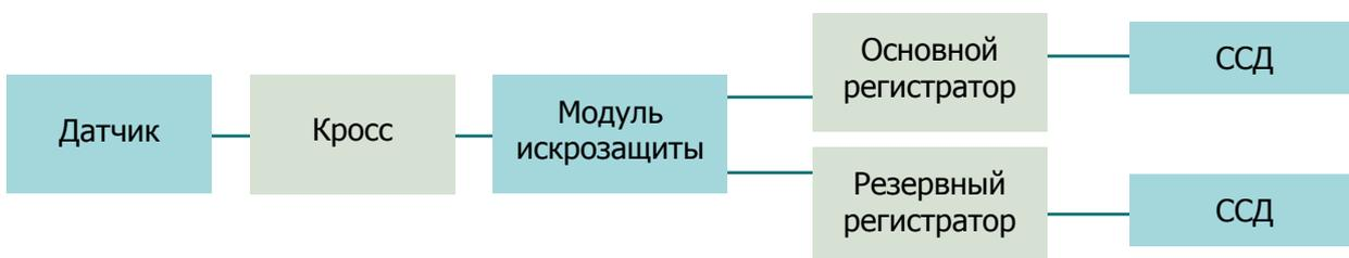
Структура дублированного измерительного канала
