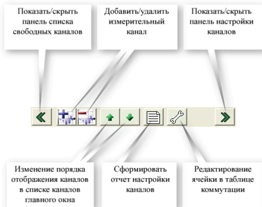
Рис 8.4.8. Панель управления вкладкой "Каналы".
