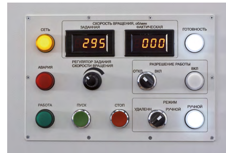
Система управления вращением платформы испытательного стенда
