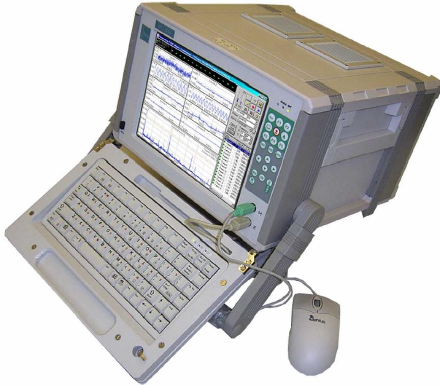
Рис.1. Типовой вид программы MR-300 в составе прибора МІС-300М. Обеспечивается вывод измеряемых величин и преобразованных параметров на дисплей одновременно по произвольному количеству каналов (до 24).
